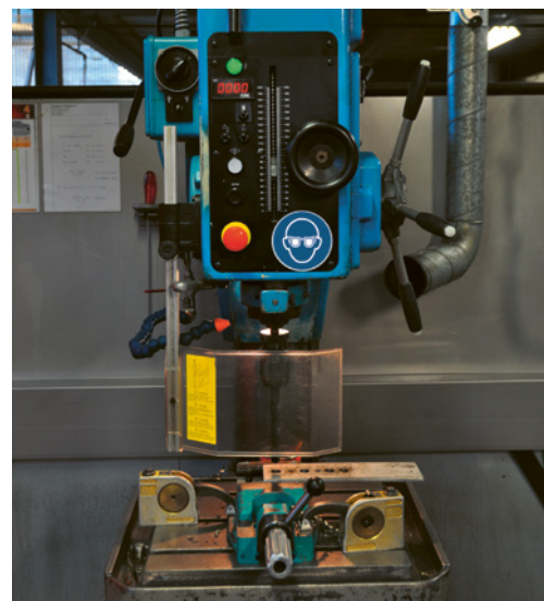
4 Verriegelte, trennende Schutzvorrichtung: schwenkbare Bohrer-Verdeckung
