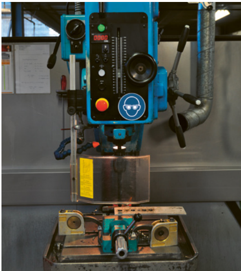
4 Verriegelte, trennende Schutzvorrichtung: schwenkbare Bohrer-Verdeckung
