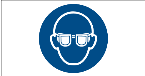
5 Das Gebotszeichen Augenschutz benutzen ist für den Bediener gut sichtbar an die Bohrmaschine anzubringen.
