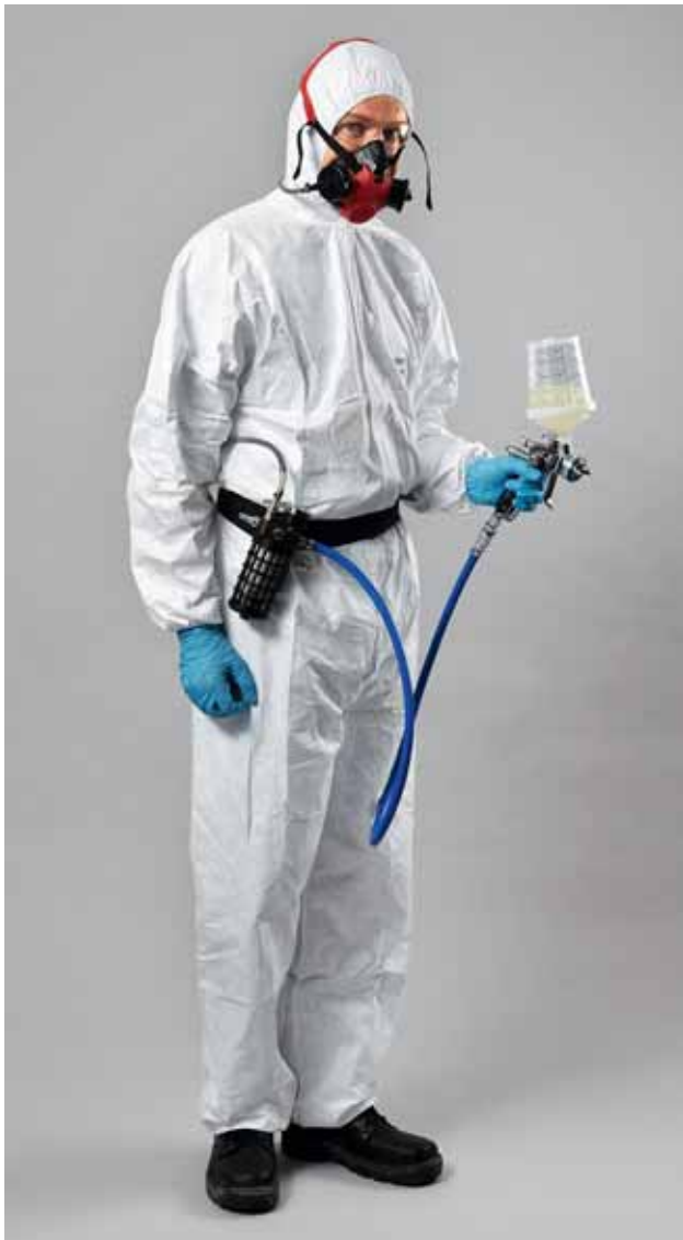
Fig. 9: EPI complet: appareil à adduction d'air comprimé selon la norme SN EN 14594 de la classe 3 avec demi-masque, lunettes de protection, combinaison de protection contre les produits chimiques (type 5) et gants. Le tuyau d'air comprimé est relié à la ceinture et alimente en air le demi-masque et le pistolet de pulvérisation.
