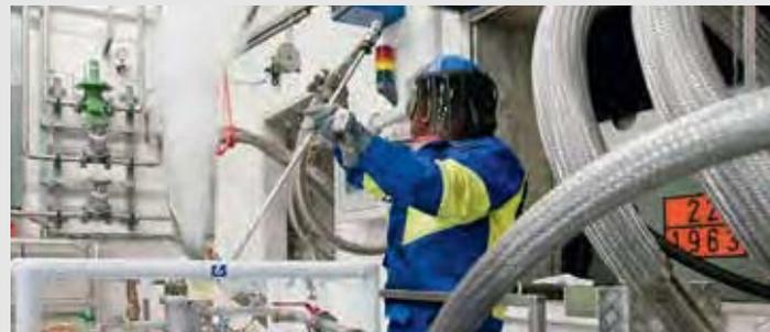
Travasamento di elio liquido (-269°C) in impianto di riempimento gas speciali.
