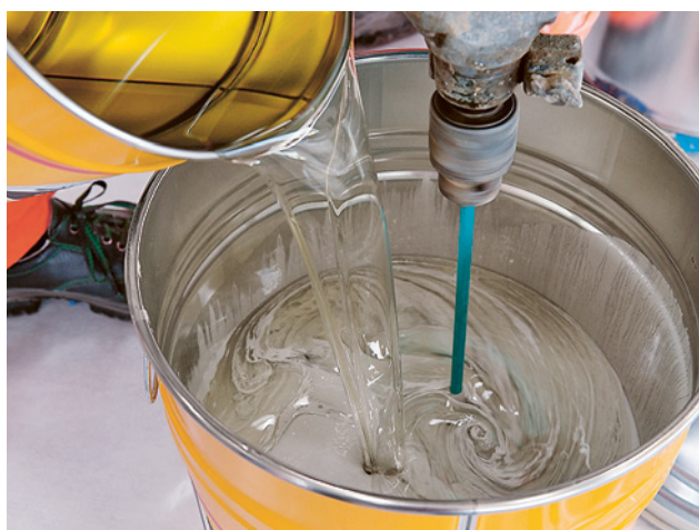
6 Le componenti della resina sintetica reagiscono fra loro. Può essere pericoloso per la salute.
