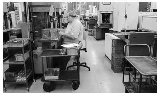
Fig. 1 : l'opérateur doit pouvoir disposer d'un emplacement d'au moins 800 mm pour éviter d'être bousculé
