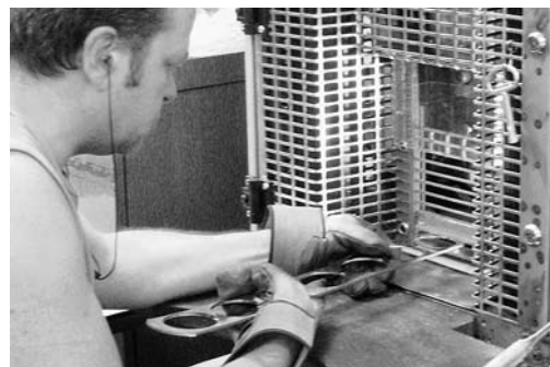
Fig. 2 : découpage de bandes au travers d'un guichet mobile. Un barrage immatériel avec une ouverture flottante est également possible.
