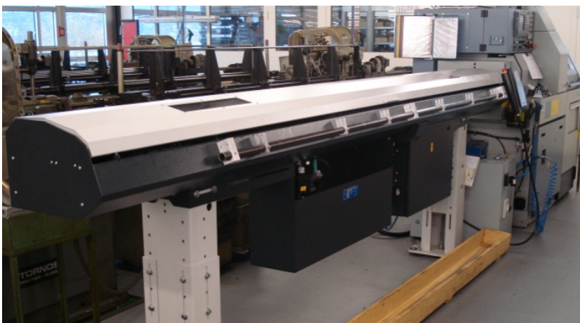
1 Caricatore automatico di barre con rampa di carico laterale
