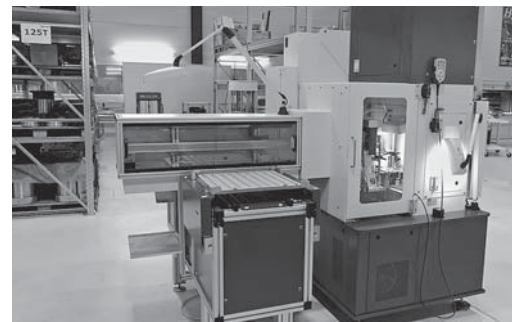
Bild 4: Alle Gefahrenbereiche der Presse und der automatischen Beschickungseinrichtung müssen korrekt gesichert sein.
