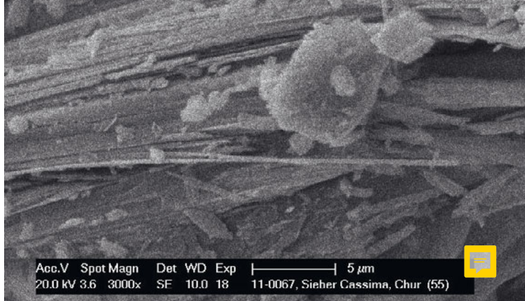
Figura 3: Immagine con microscopio elettronico a scansione di tremolite di amianto con pronunciata scissione longitudinale e frammentazione in finissimi aghi cristallini fibrosi (foto: Suva).
