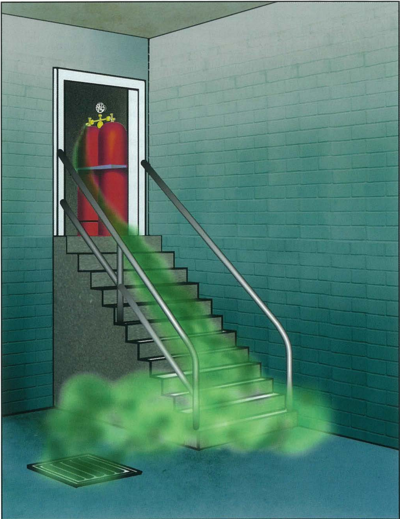
Bild 6: Ausbreitungsverhalten am Beispiel von Flüssiggas
