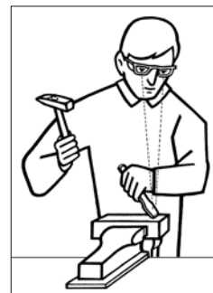
9 Richtige Arbeitsweise beim Meisseln: Werkstück in Schraubstock eingespannt, Hammer richtig gefasst, Blick auf die Meisselschneide gerichtet, Schutzbrille.
