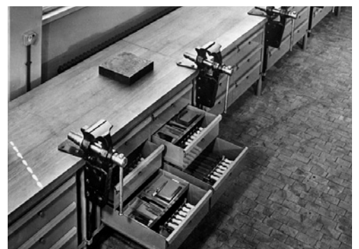
10 Ideal ist, wenn jeder Handwerker über seine eigenen Handwerkzeuge mit einem eigenen Aufbewahrungsort verfügt.
