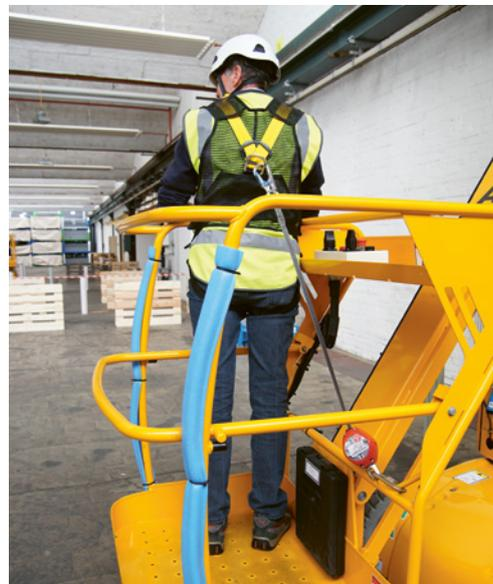
1 Con le piattaforme di lavoro a braccio articolato o telescopico il pericolo di caduta dall'alto è maggiore. Ogni persona presente sulla piattaforma deve essere munita di un sistema di ritenuta (imbracatura e cordino regolabile lungo al massimo 1,8m) e di un casco di protezione con cinturino sottogola.
