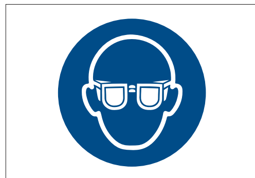
5 Se vige l'obbligo di portare gli occhiali di protezione applicare il relativo cartello ( www.suva.ch/1729-2.k ) nella zona di lavoro.
