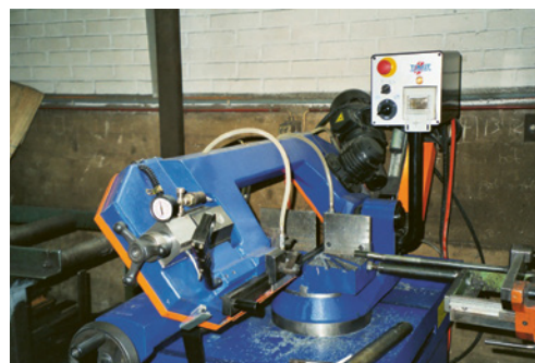
3 La lama a nastro è schermata completamente.
