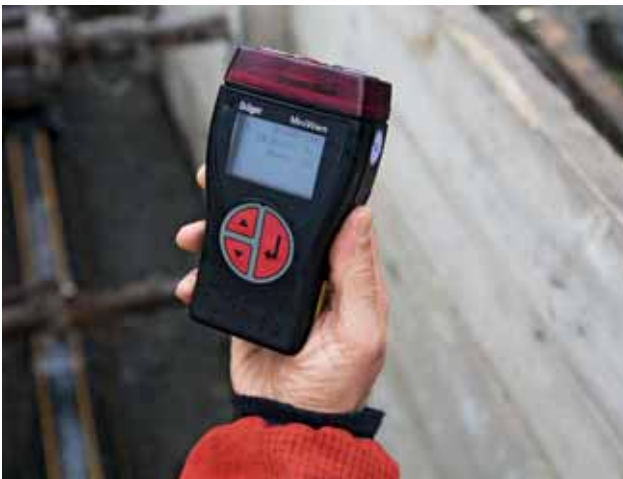
Fig. 18: appareil de mesures multifonctions pour oxygène, méthane, monoxyde de carbone.
