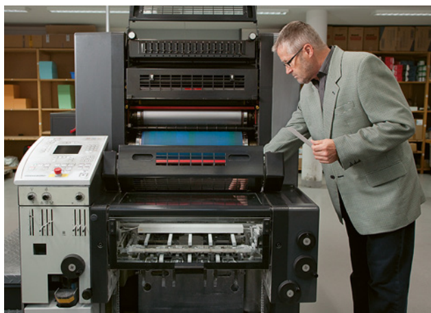
6 Verifica della macchina prima della messa in servizio
