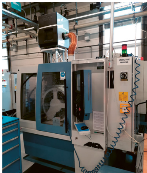
2 Macchina incapsulata provvista di aspiratore e filtro elettrostatico.
