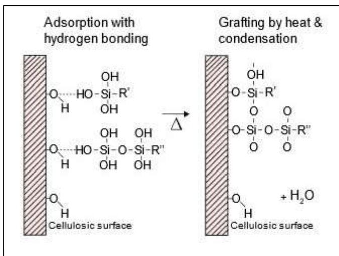
III. 2: Meccanismo del trattamento superficiale sull'esempio di un trialcossilano (modified from Xie et al. 2010).
