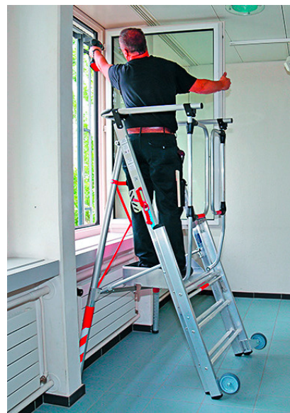
25 Mobile Podestleitern können gemäss Herstellerangaben auch mit einer Standhöhe von mehr als 2 Metern verwendet werden.
