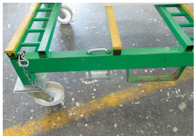
2 Transportgestell mit demontierbaren Rädern, Krananslagpunkten und Gabelzinkenlaschen (für Staplertransport)
