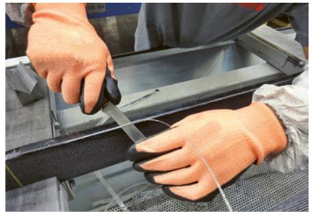
6 Einseitig beschichtete Schnittschutzhandschuhe bieten guten Haut- und Schnittschutz bei Tätigkeiten mit leicht öligen und scharfkantigen Teilen.
