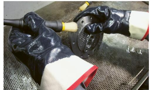
4 Nur für den Gefahrenstoff geeignete chemikalienresistente Schutzhandschuhe bieten einen optimalen Hautschutz.
