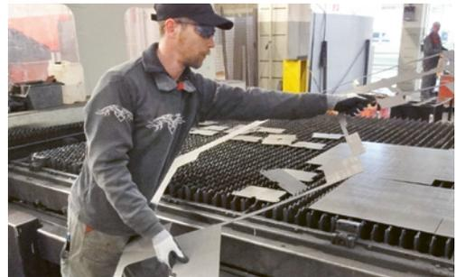
1 Mitarbeiter trägt Schutzhandschuhe mit einer Schnittfestigkeit  $\geq 3$  (2003) bzw.  $\geq C$  (2016) bei der Handhabung von scharfkantigen Blechen.
