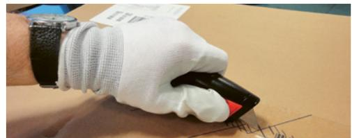
2 Sicherheitsmesser mit Klängenrückzug zum Aufschneiden von Verpackungen.
