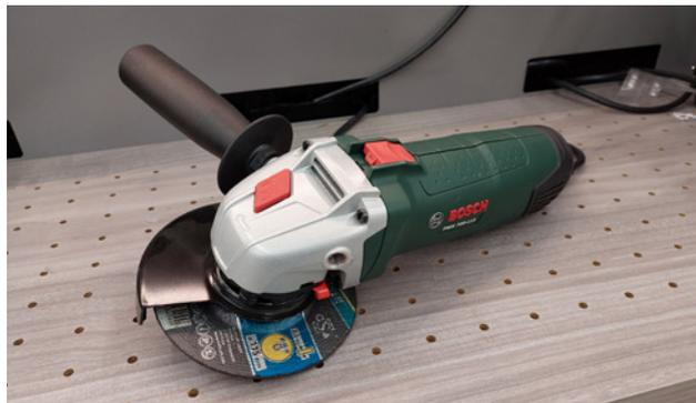
**Figura 1** Troncatrice a mola con dispositivo di sicurezza
