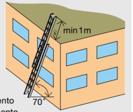
Impedire il ribaltamento e lo slittamento della scala
