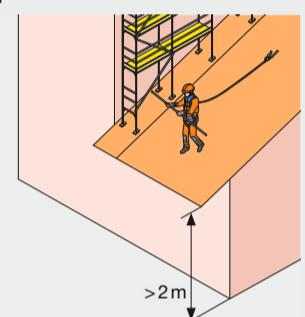
Superficie non resistente alla rottura
