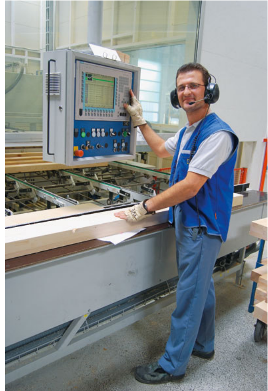
Die Maschine ist komplett mit 4B-Schallschutzglas eingehaust. Die Mitarbeitenden kommunizieren über Mikrofon und Kopfhörer.
