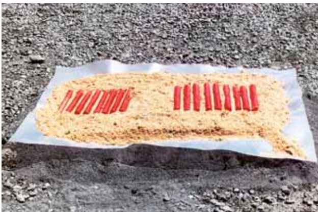
Fig. 6: emplacement de combustion sur un lit de sable recouvert d'une pellicule de matière synthétique et de sciure.
