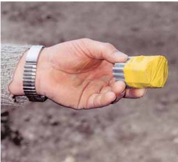
Fig. 1: l'ouverture des détonateurs est obturée par du ruban adhésif.
