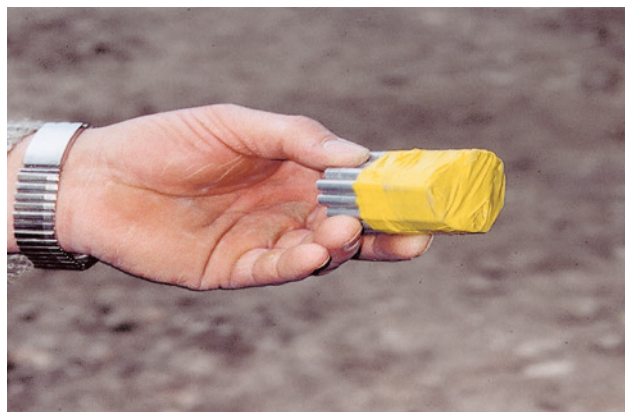
1 L'ouverture des détonateurs est obturée par du ruban adhésif.
