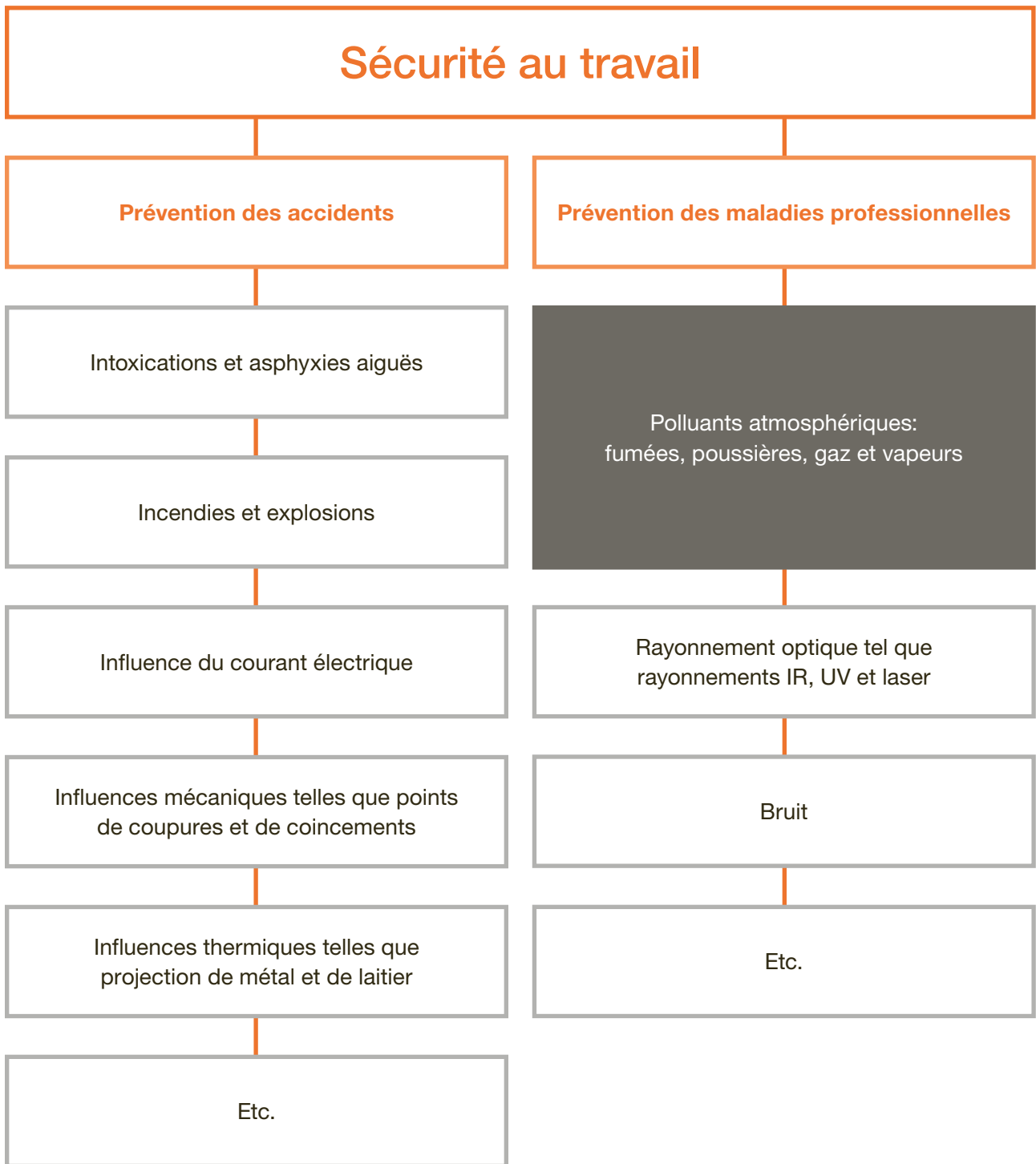
Fig. 1 Aspects de la sécurité au travail à prendre en compte durant les travaux de soudage et de coupage
