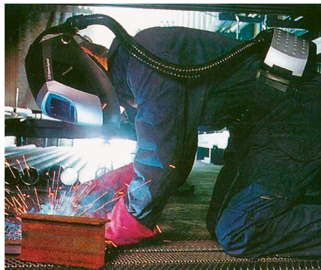
Fig. 41 Appareil filtrant à ventilation assistée avec casque de soudage et filtre antigaz et à particules combiné selon SN EN 12941 (niveau de protection TH2 A1E1B1P)
