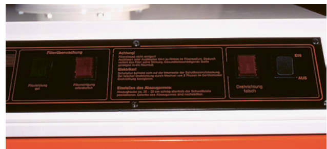
Fig. 39 Surveillance automatique du filtre
