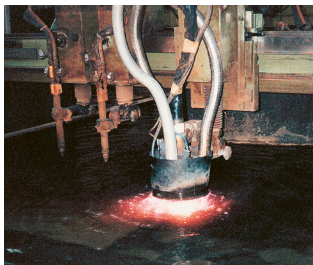
Fig. 31 Coupage par jet de plasma sous l'eau d'aciers au chrome-nickel
