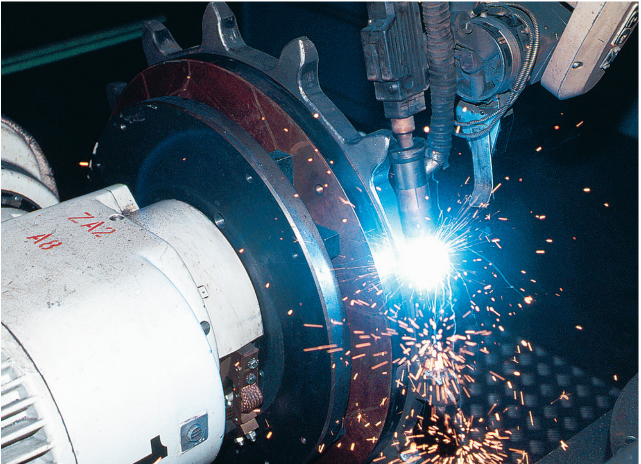
Fig. 5 Soudage de recharge automatique
