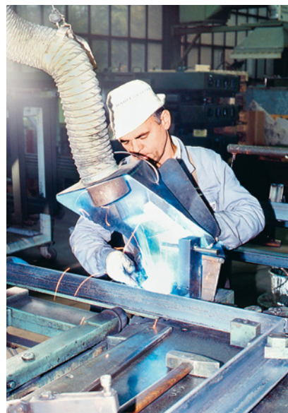
Fig. 35 Aspiration sur l'écran protecteur
