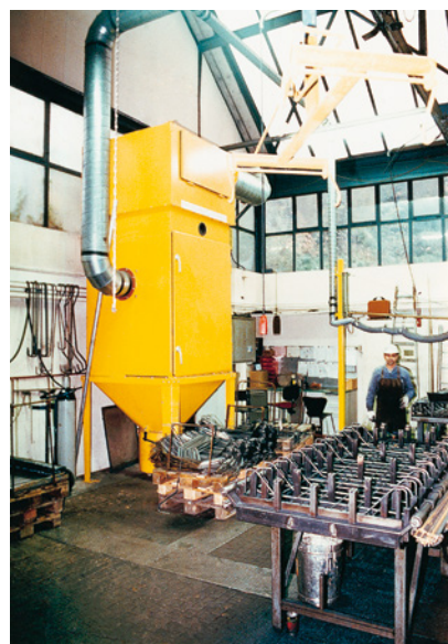
Fig. 38 Installation centrale de dépolluissage pour fumée de soudage et poussières de meulage
