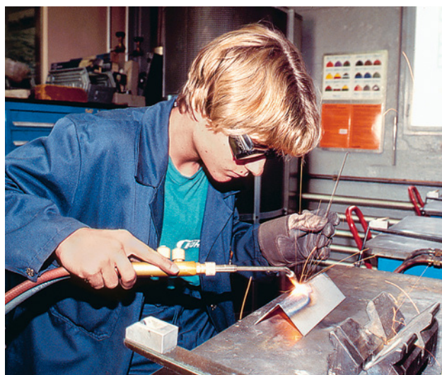
Fig. 22 Soudage au gaz
