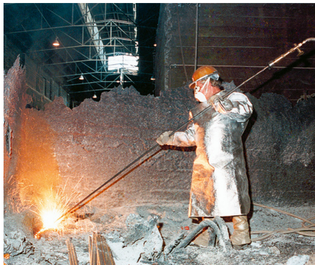
Fig. 25 Oxycoupage au moyen d'une lance à oxygène
