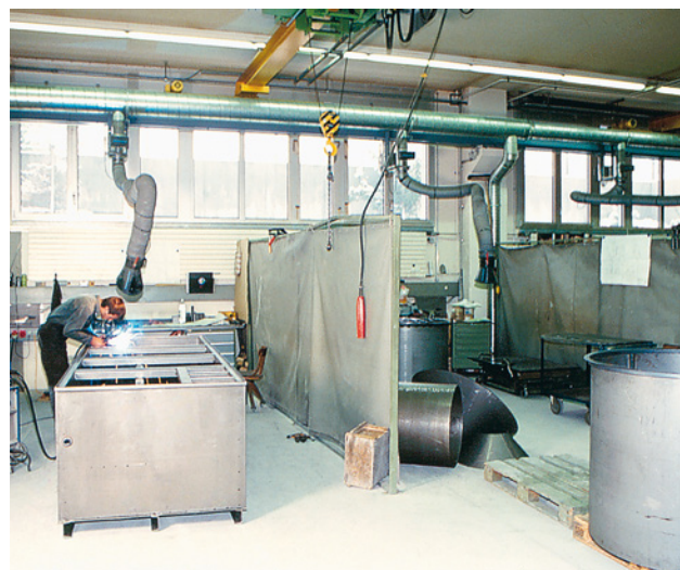
Fig. 36 Bras d'aspiration flexible de grande portée
