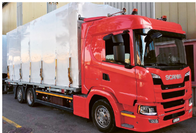
2 Messa in sicurezza della piattaforma scarrabile con il sistema twistlock. I prefabbricati durante il trasporto sono protetti contro gli agenti atmosferici da una pellicola bianca.
