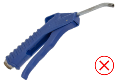
Manipulierte (abgesägte) Blaspistole
