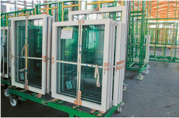
3 Transporte können nur dann sicher durchgeführt werden, wenn die Transportgestelle korrekt beladen wurden.
