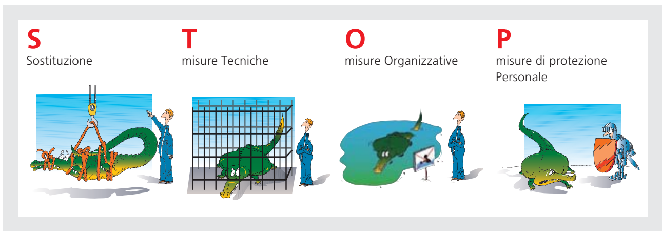
Figura 2: le misure di protezione devono avere la priorità secondo il principio STOP
