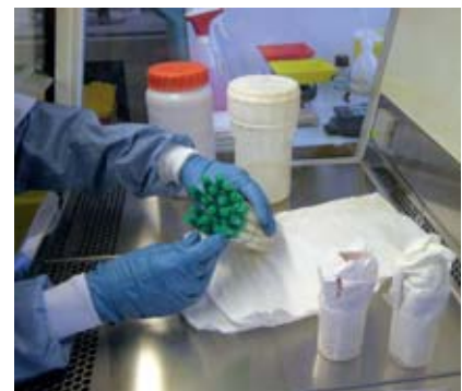
Figura 3: i lavori con microrganismi nei quali è possibile la trasmissione via aerosol vengono effettuati in una cappa a flusso laminare microbiologica.
