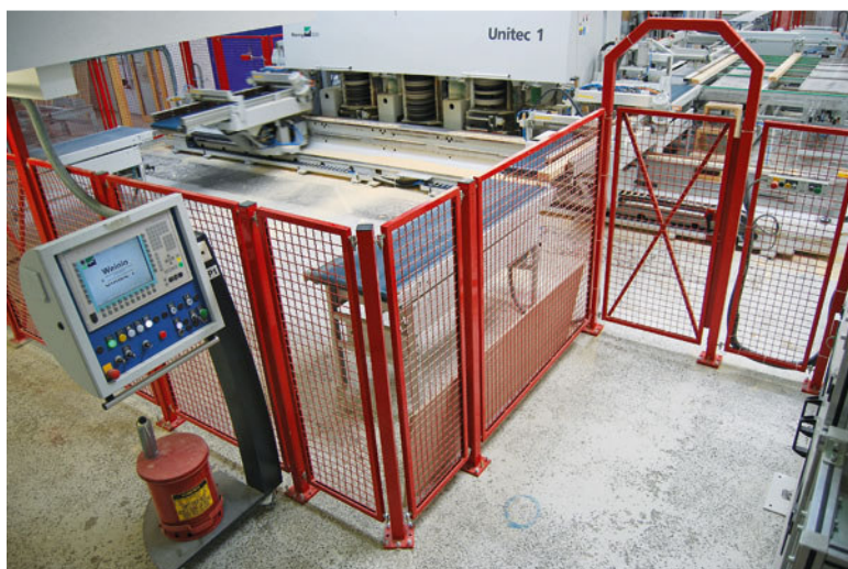
Tutte le zone pericolose sono delimitate da griglie dotate di dispositivi elettronici.
