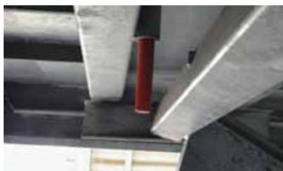
**02** // Die Sicherheitsbolzen blockieren die Querverstreife auf der Unterseite der Plattform. Dadurch kann sich die Plattform nicht absenken.
