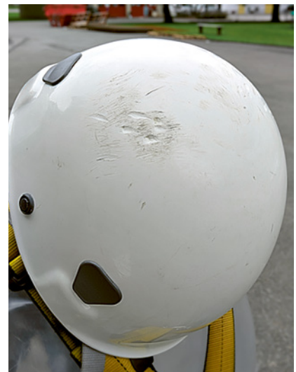
3 Va sostituito anche questo casco di protezione con un difetto visibile.
