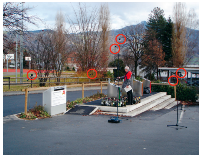
Bild 16 Messung der Schalldruckpegel mit sechs Mikrofonen bei einem modernen Altglas-Sammelsystem. Die Mikrofone sind mit einem Kreis gekennzeichnet.
