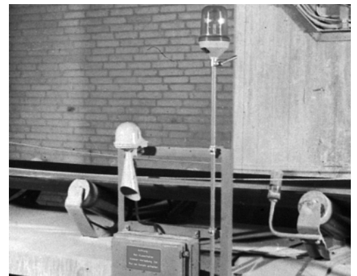
Bild 11: Anlaufwarneinrichtung. Je nach Situation können akustische oder optische Signale ausgestossen werden. Auch eine Kombination ist zum Teil sinnvoll.
