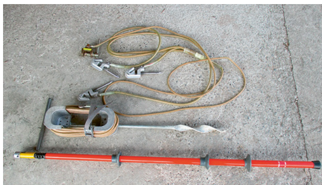
1 Apparecchiatura di messa a terra per alta tensione (le apparecchiature di messa a terra devono sopportare sollecitazioni di tipo dinamico e termico)
