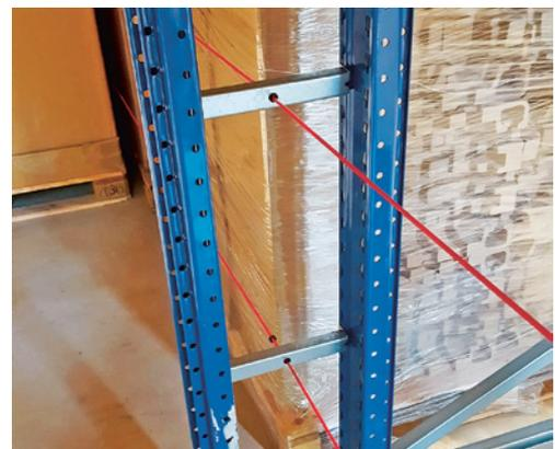
3 Des dispositifs de retenue (chaînes, profilés de rayonnages, grilles ou câbles métalliques) doivent être placés jusqu'à 1 m de hauteur au minimum pour empêcher toute personne de passer au travers des rayonnages (hauteur libre 0,5 m max.).
