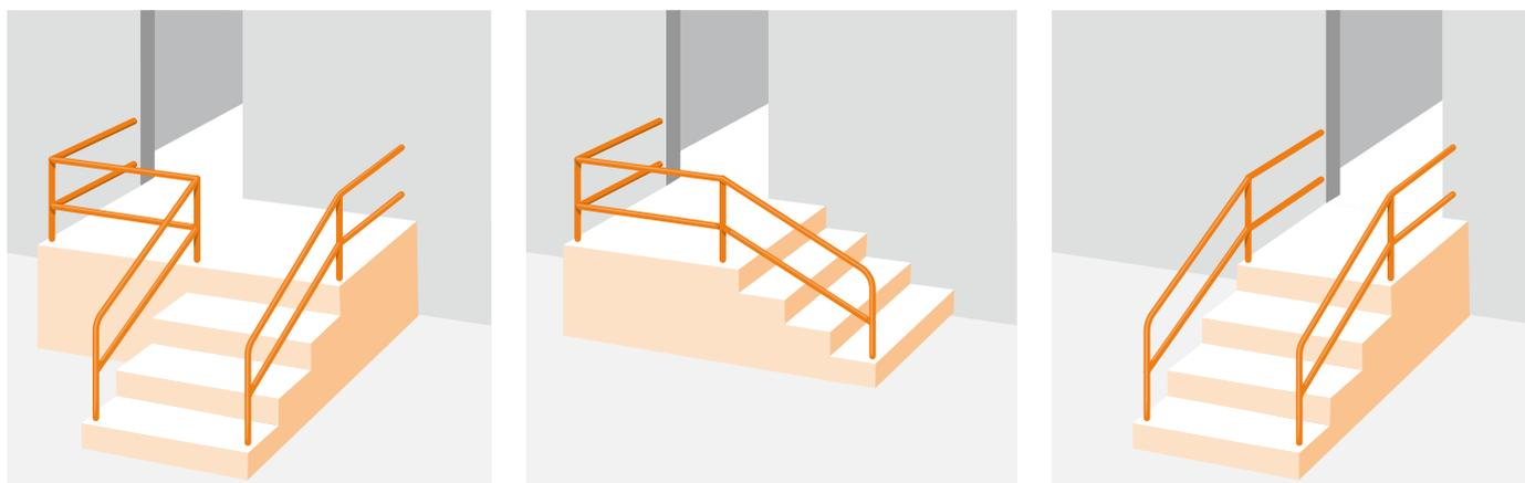
1 Una scala posta dietro l'apertura in una parete o dietro una porta rappresenta un pericolo imprevisto (pericolo di caduta). In questo caso occorre metterla in sicurezza con un pianerottolo munito di parapetto e bordi fermapiede. Questi ultimi sono un'ulteriore misura di sicurezza in caso di rotolamento di oggetti o scivolamento di persone.
