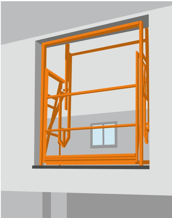
4 Cancello di sicurezza in prossimità di un'apertura nella parete. Nella lista di controllo «Punti di carico e scarico per il trasporto di merci con gru e carrelli elevatori» ([www.suva.ch/67123.i](http://www.suva.ch/67123.i)) sono riportati ulteriori esempi di cancelli di sicurezza. Questi dispositivi di sicurezza sono adatti anche per le aperture nelle pareti.
