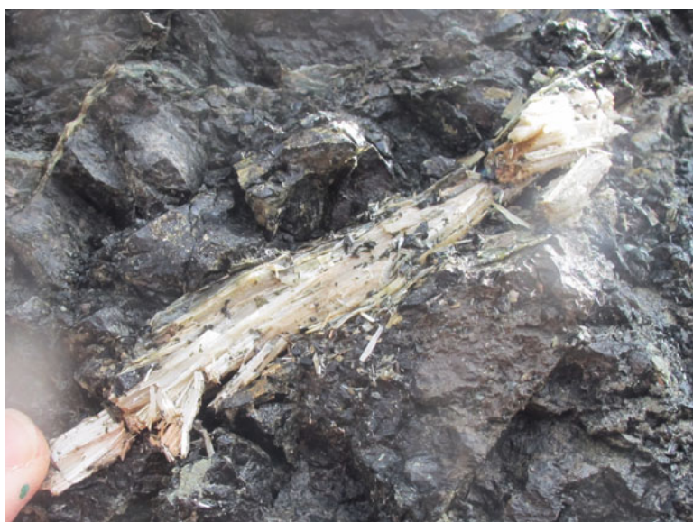
Bild 1: Dunkles Serpentinittgestein mit geringmächtigen Chrysotilkluft (Weissasbest) aus dem Oberhalbstein, CH (Bild SC+H AG).
