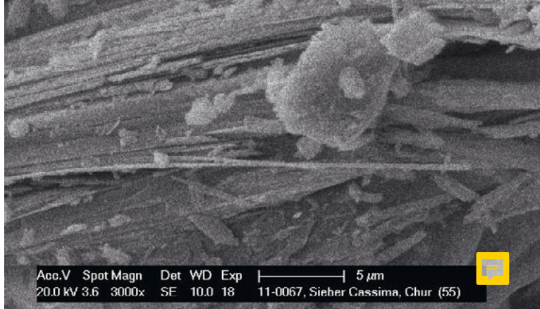
Bild 3: Rasterelektronenmikroskopische Aufnahme von asbestlosem Tremolit mit ausgeprägter Längsspaltbarkeit und Zersplitterung in feinste, fibröse Kristallnadeln (Bild SUVA).
