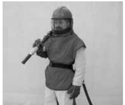
Figure 5: l'équipement de protection individuelle comprend un appareil de protection respiratoire, une protection contre les chocs pour les épaules et le corps, des gants de protection, des vêtements de travail fermés.
