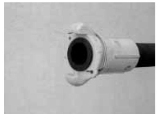
Figure 3: tuyau de sablage avec goupille de sécurité.
