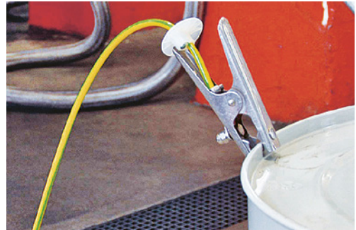
2 Pince de mise à la terre fixée sur le bord d'un fût.
