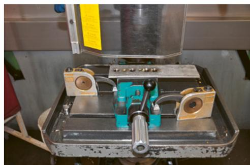
3 Morsa dotata di meccanismo di bloccaggio rapido
