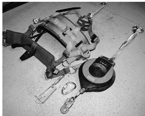
10 Harnais, moyens auxiliaires (mousqueton, etc.) et antichute à rappel automatique avec manivelle de sauvetage
