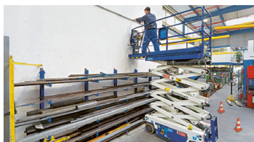
2 Hubarbeitsbühne für Installations- und Reinigungsarbeiten in der Höhe.
