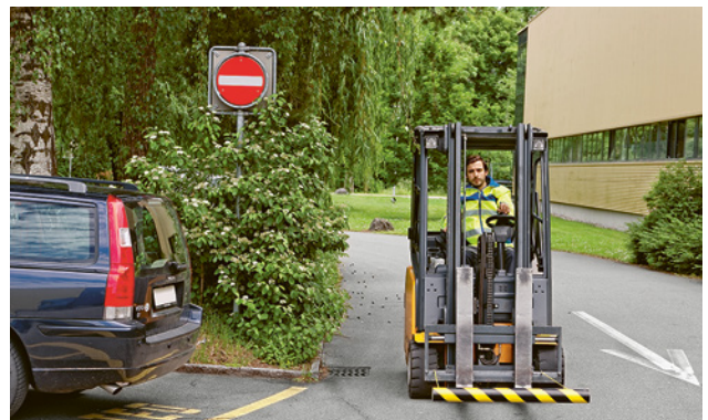
12 Gabelzinken mit Schutzbalken
