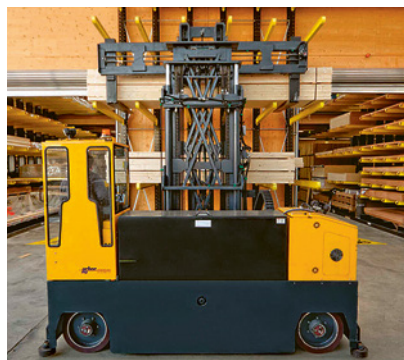
2 Seitenstapler für den Transport von Langgütern
