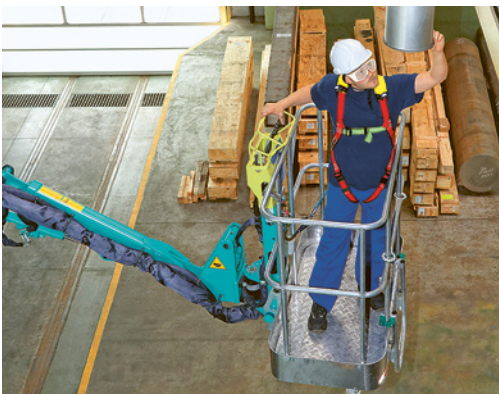
1 Hubarbeitsbühne für Lampenwechsel in der Höhe
