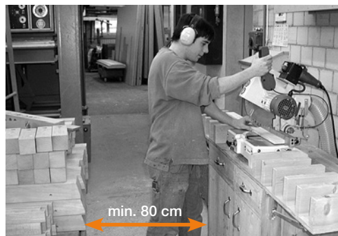
3 L'operatore deve avere almeno 80 cm di spazio attorno alla macchina per lavorare in condizioni di sicurezza.
