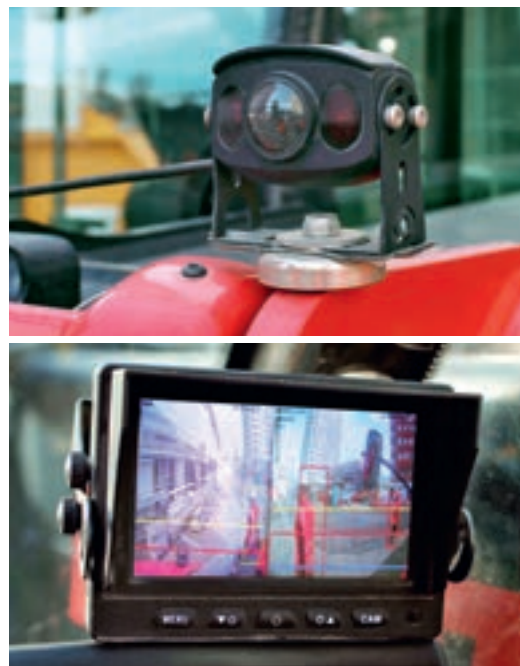
Le videocamere sulle macchine di Losinger Marazzi segnalano il rischio di collisione con i pedoni.
