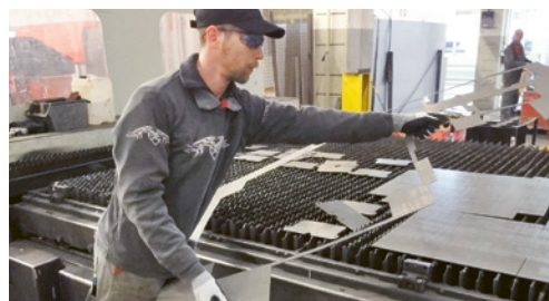
1 Travailleur portant des gants de protection de résistance à la coupure \geq 3 (2003) ou \geq C (2016) pour manipuler des tôles à arêtes vives.
