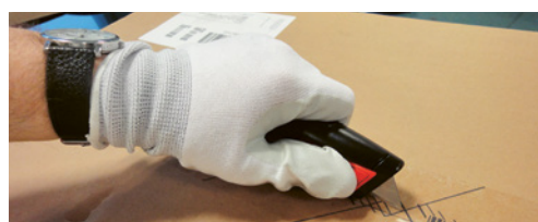
2 Couteau de sécurité avec lame rétractable pour découper des emballages
