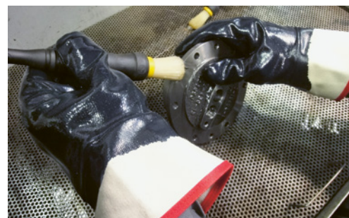
4 Des gants résistants aux produits chimiques et adaptés à la substance dangereuse utilisée garantissent une protection cutanée optimale.
