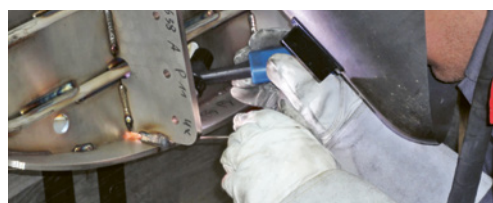
3 Gants de protection pour soudeurs résistants à la chaleur et offrant une bonne sensibilité tactile
