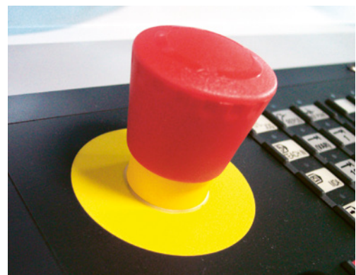
4 Not-Halt-Gerät mit Drucktaster
