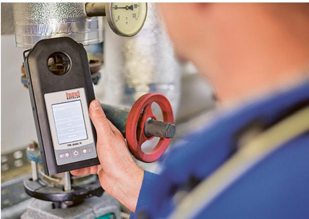
1 Handmessgerät für Staubmessungen
